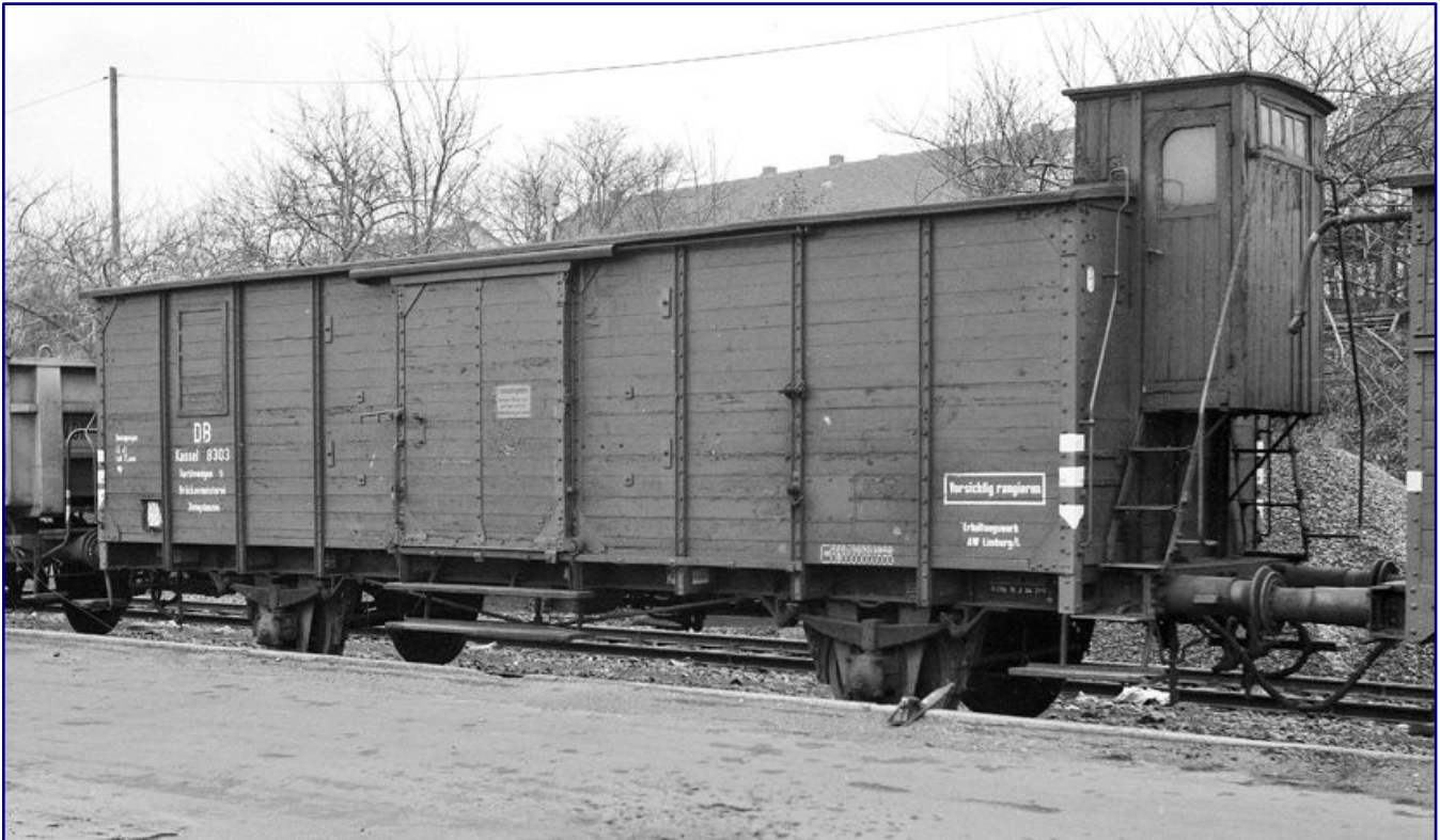
Der Gerätewagen 9 „Kassel 8 303“ der Brückenmeisterei Dieringhausen veranschaulicht im Dezember 1964 im Bahnhof Kassel-Wilhelmshöhe, wie den verkehrlichen Ansprüchen nicht mehr gewachsene Fahrzeuge eine Zweitnutzung als Dienstgüterwagen erfahren. Foto: Reinhard Todt, Eisenbahnstiftung
