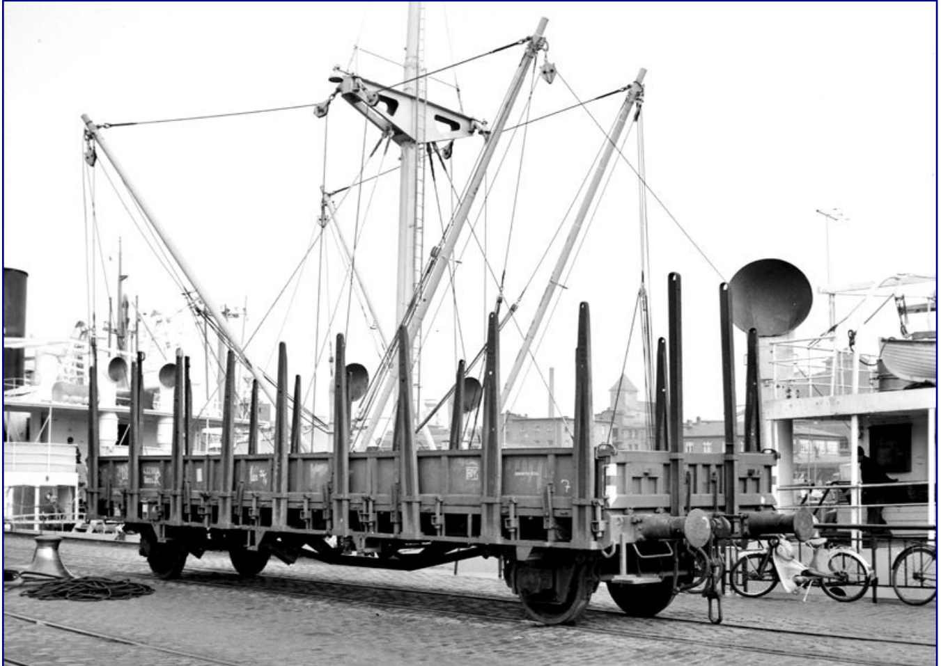
Dieser Rungenwagen Rmms 33 mit der Betriebsnummer 432 888 wurde im September 1960 in Bremerhaven abgelichtet. Schon nicht mehr alltäglich war seinerzeit, dass er noch mit Rungen genutzt wurde. Später wurden Vertreter dieser Bauart bis in die Neunziger hinein noch als Dienstgüterwagen oder Bahndienstwagen genutzt. Foto: Reinhard Todt, Eisenbahnstiftung
