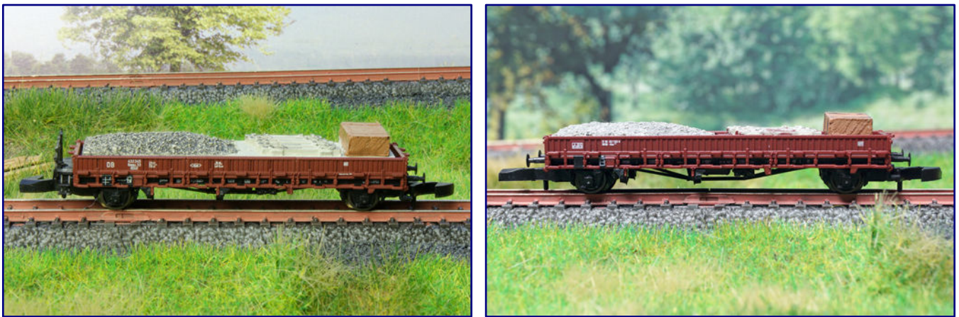
Den Vergleich von Werkzustand (links) und erfolgter Nacharbeit am Einsatz (rechts) soll diese Gegenüberstellung ermöglichen: Das Ladegut sitzt nun deutlich tiefer im Waggon und schaut nicht mehr über den Rand.
