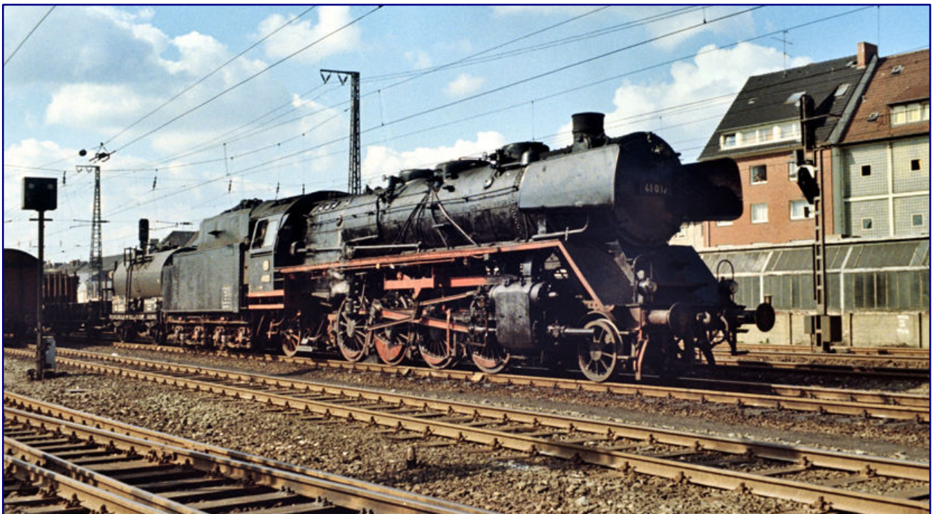
Das Bild der Kastentender an DRG-Einheitslokomotiven ist weit bunter, als es Hersteller Märklin uns glauben machen will: Hier präsentiert sich 41 032 (mit Altbaukessel) aus dem Bw Rheine in Münster (Westf.) Gbf am 11. April 1968 dem Fotografen. Mit ihr gekoppelt ist ein genieteter 2'2' T 32, den sie erst nach 1945 erhielt. Foto: Bernd Kappel, Eisenbahnstiftung
