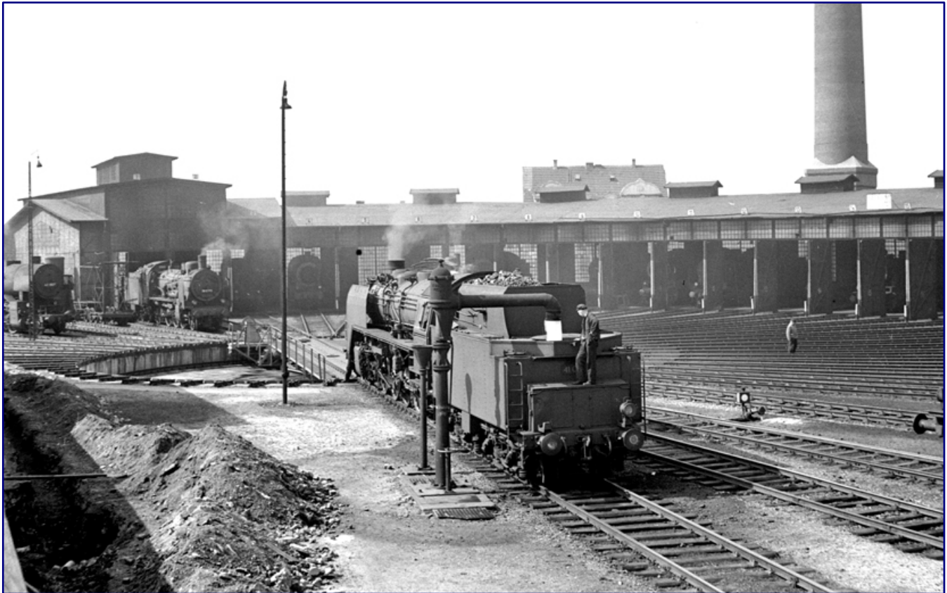
41 010 (Bw Mönchengladbach) restauriert 1950 im Bw Duisburg Hbf, dass 1966 stillgelegt wurde. Die Dampflok hat inzwischen auch ihren Tender abgegeben und hat im Tausch einen 2'2' T 32 erhalten. Im Hintergrund sind 38 3772 und 42 1507 zu sehen. Foto: Willi Marotz, Eisenbahnstiftung
