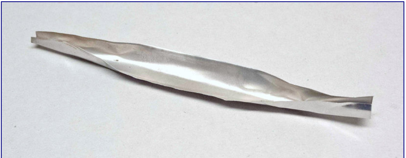
Unscheinbar, aber wertvoll: selbstgebautes Schüttwerkzeug aus Aluminiumblech zum Verteilen von Schotter und Kleinschlag.
