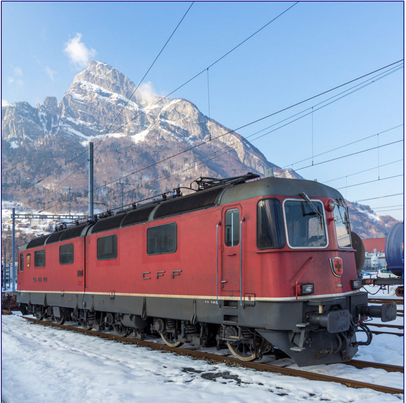
Dieselbe Lok wie auf Seite 5 zeigt sich hier nach ihrer Modernisierung am 17. Februar 2013 in Buchs/SG. Deutlich zu sehen ist der geteilte Lokkasten, den nur die beiden Prototypen besaßen. Foto: Joachim Kohler (CC-BY-SA-4.0)
