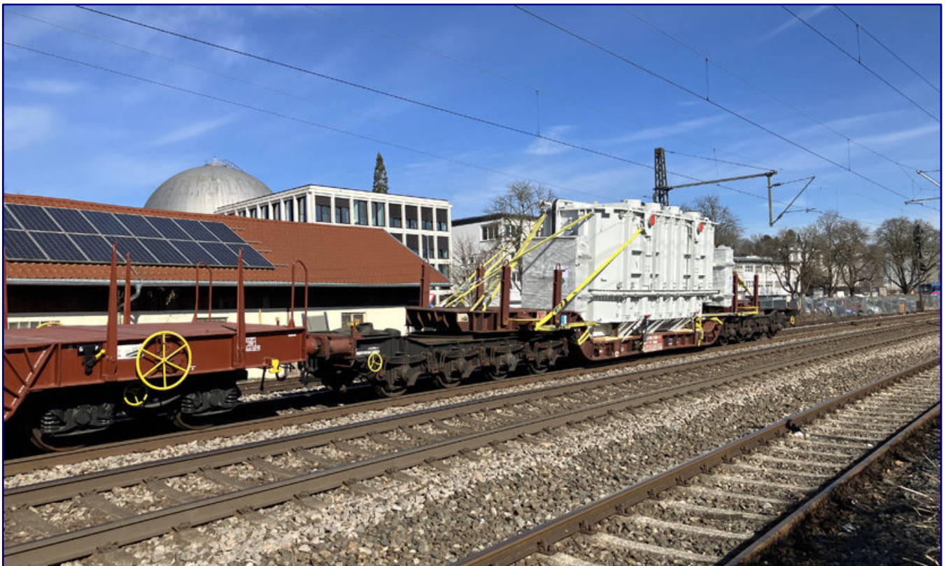
Der aus Italien stammende, achtsachsige Tiefladewagen Uaais mit der UIC-Nummer 31 83 994 5 001-0 I-MIR hängt am 21. Februar 2025 mit schwerer Fracht am Ende eines Güterzugs, der die Geislinger Steige herabgefahren ist und nun Göppingen erreicht hat. Foto: Matthias Vogel
