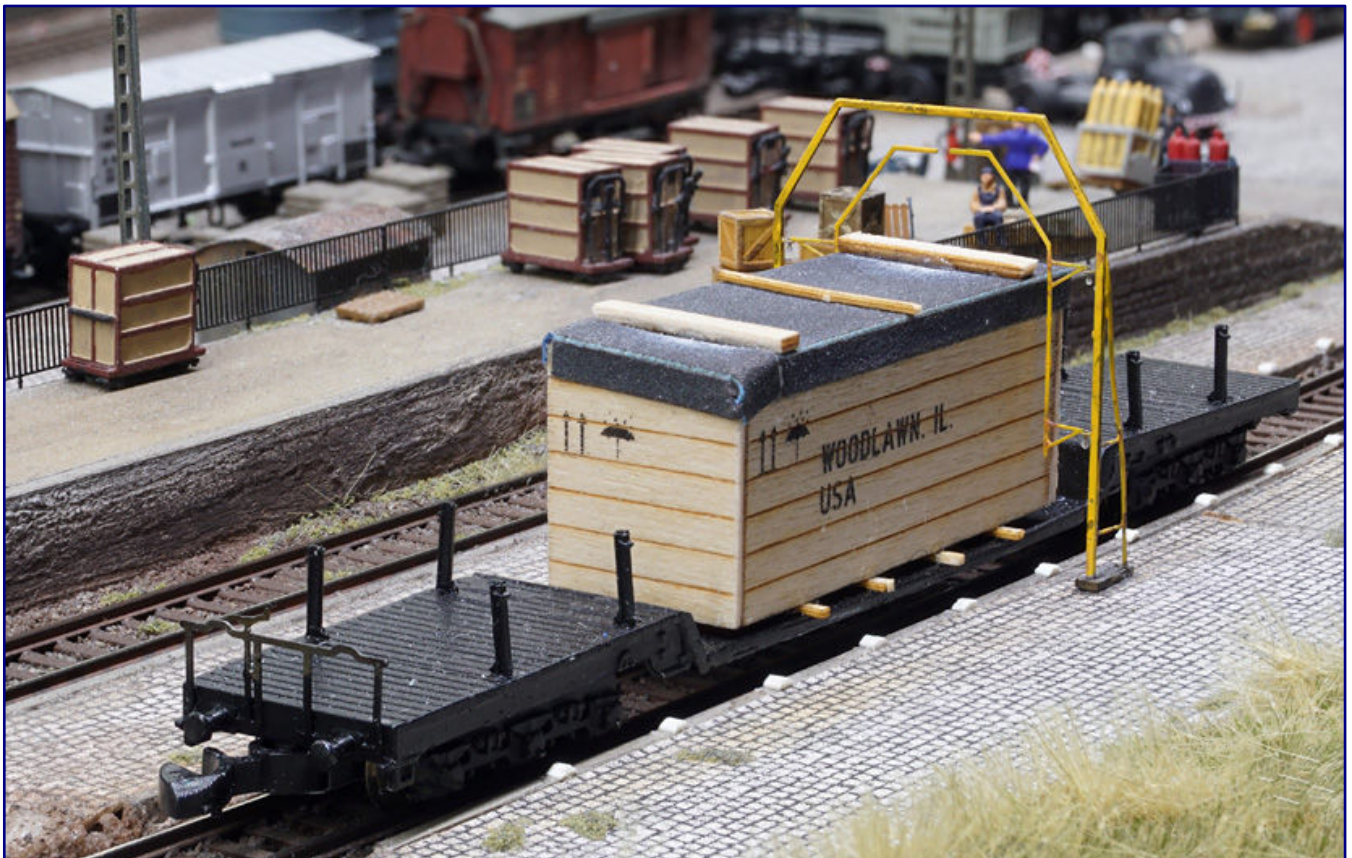
Der Waggon passt mit verladener Maschinenkiste durch das Umgrenzungsprofil des Lademaßes. Deshalb darf er in Regelgüterzüge eingestellt werden und verkehrt ohne besondere Vorsichtsmaßnahmen.
