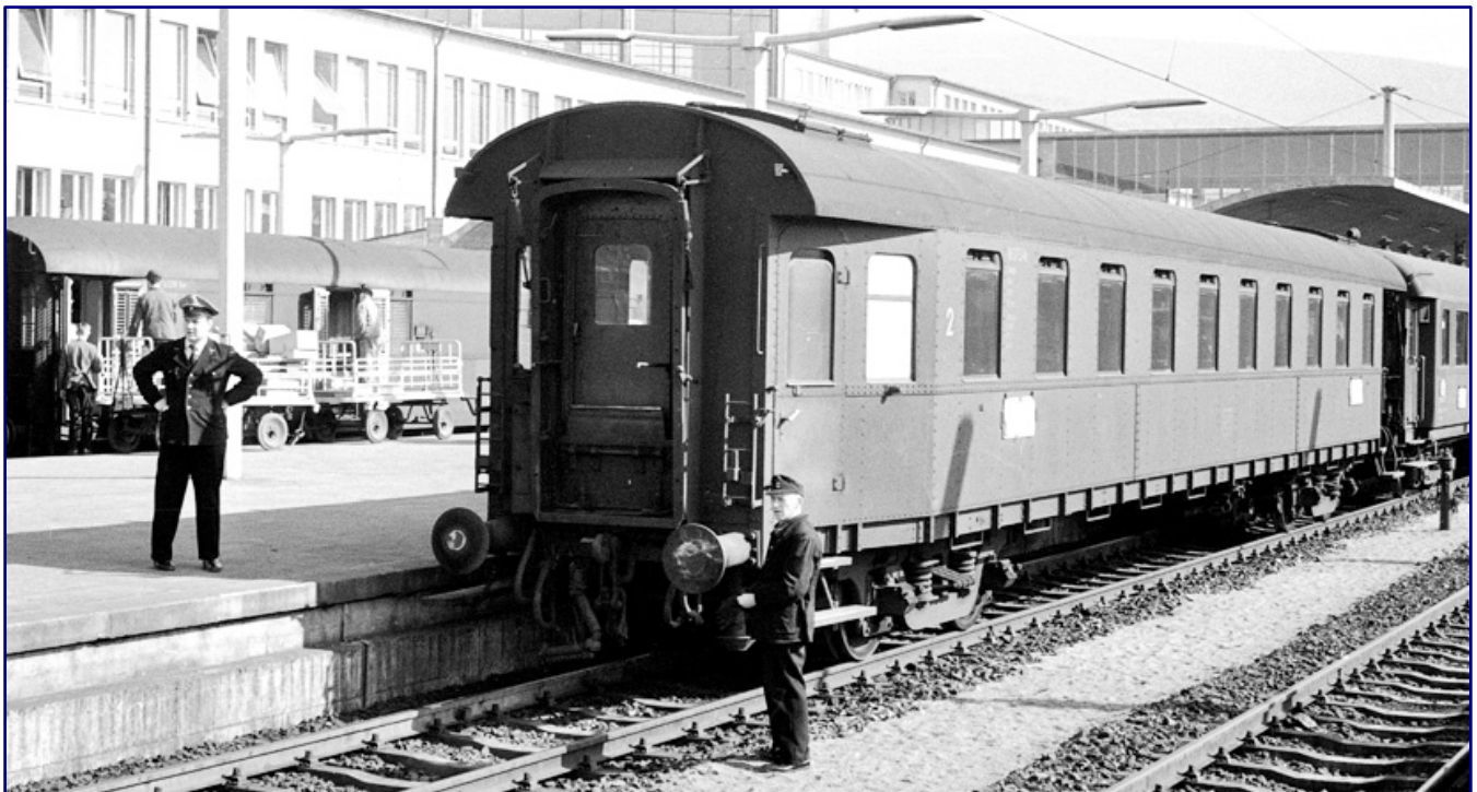
Der C4ü-26 (Bauart 1926) lief auf Schwanenhalsdrehgestellen mit nur 2.150 mm Achsstand. Die Wagenenden entsprechen noch den Hechtwagen (Bauart 1921 – 1923), während schon ein durchgehendes Tonnendach zum Einsatz kam. Damit bildete er den Übergang zur Bauart 1928 bis 1930. Foto: Karl Friedrich Walbrach | Eisenbahnstiftung
