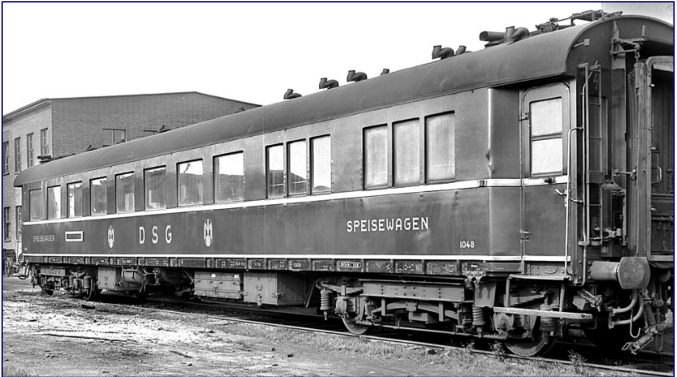
Der 1956 fotografierte DSG-Speisewagen 1048 ist ein WR4ü(e)-28 und gehört damit zur Bauart 1928. Die Niete der Außenbleche waren bei den Speisewagen aber vertieft und bündig verspachtelt. Ausgestattet ist der erhaltene gebliebene Wagen mit Drehgestellen der Bauart „Görlitz II schwer“. Foto: Engels | Eisenbahnstiftung
